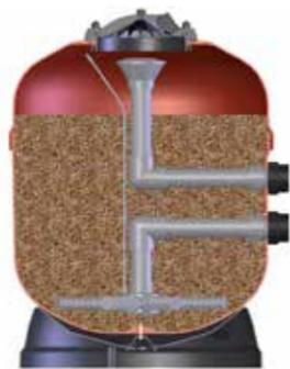
El **filtro de arena** es el más generalizado y polivalente. El agua pasa a través del lecho filtrante, arena o vidrio, que retiene las partículas en suspensión. Ofrece filtración entre 40 y 50 micras para el caso del lecho de arena y entre 1 y 40 micras para el lecho vítreo. Su mantenimiento es sencillo, basta un lavado contracorriente para eliminar las partículas retenidas.
